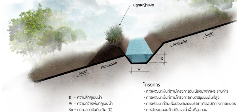
ภาพที่ 3-8 คูเบนน้ำรูปสี่เหลี่ยมคางหมู
